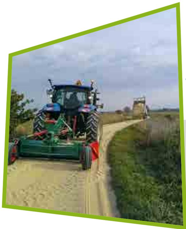
→ L'acquisition d'un nouveau matériel, une lame niveuse, permet d'entretenir nos chemins en gravier. Cette lame casse les sillons et reprofile les chemins (travail impossible à réaliser sans ce matériel). L'opération consiste à recharger avec du gravier, l'étaler avec la niveuse et passer le cylindre sur l'ensemble pour compacter les matériaux.
